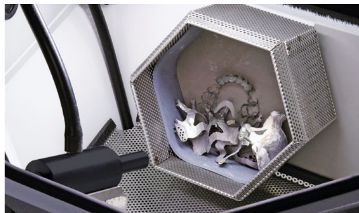
Ahorro en tiempo y costes: la gran cesta de acero giratoria facilita el arenado simultáneo de hasta 7 objetos
