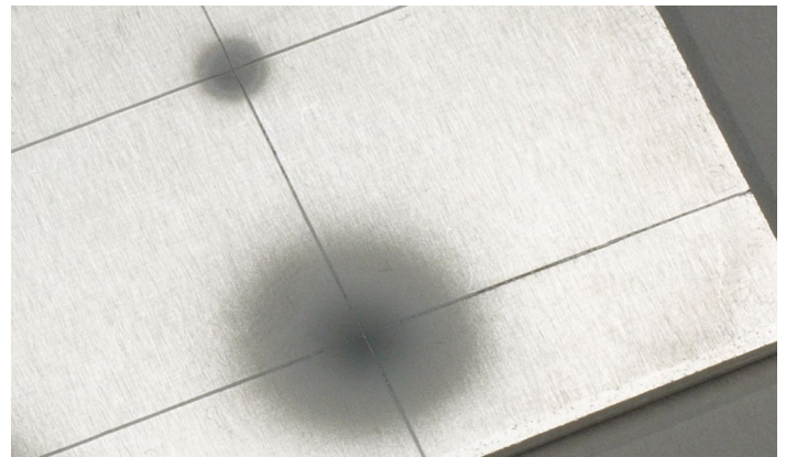
Arenado preciso y económico. Arriba: foco de chorreado Renfert. Abajo: foco de chorreado de un competidor
